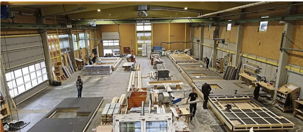
In der Produktionshalle in Maar entstehen die neuen Außenwände. SCHMIDT HAUSBAU
